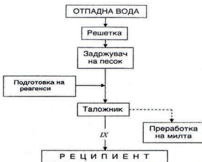
Сл. 3.28 Технолошка шема за хемиско прочистување
