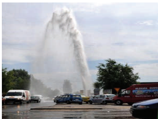
Сл.2.48 Млаз вода истекува од пукнатата водоводна цевка
